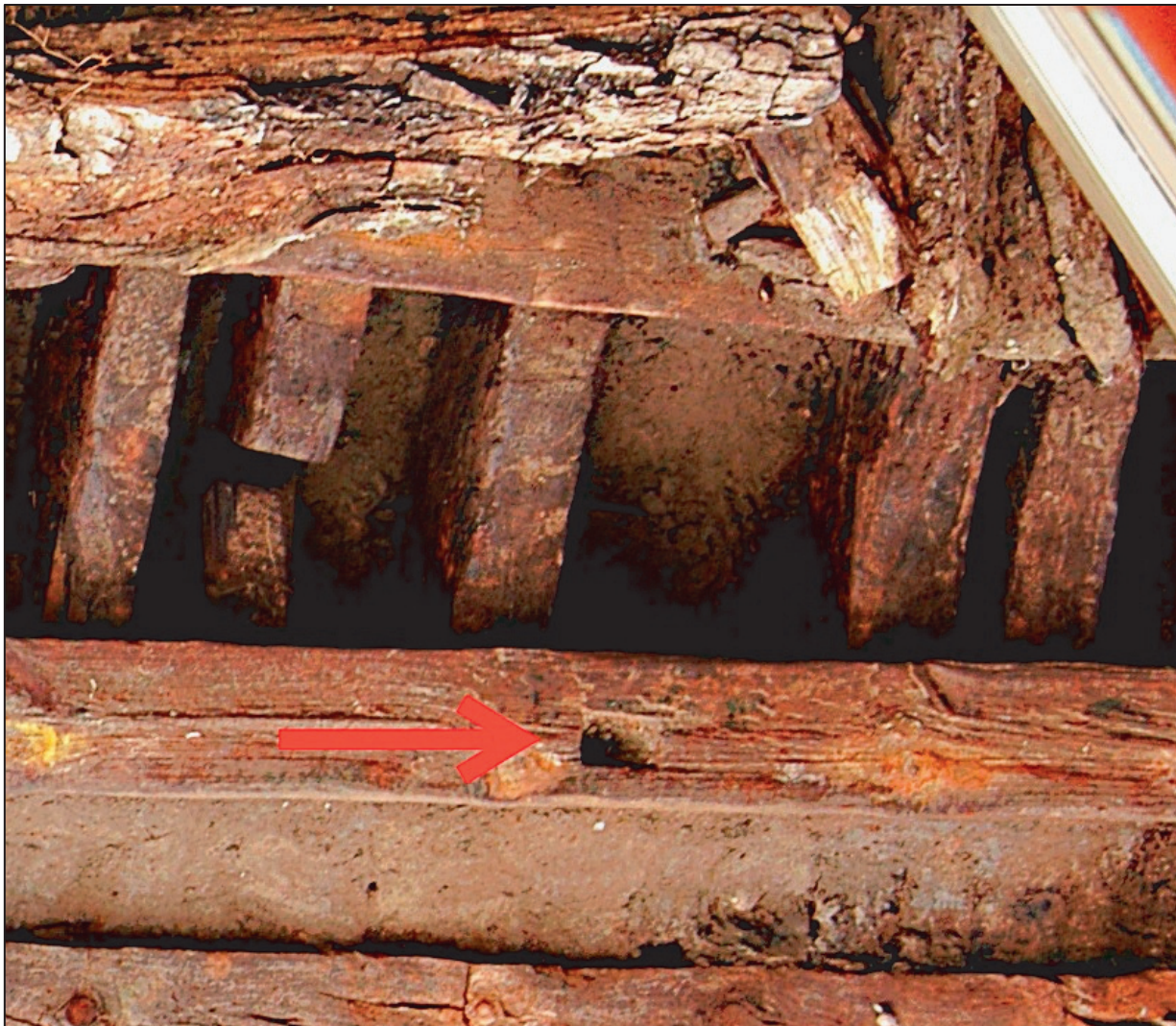
Figura 4 - Particolare dei due paramezzalini e del varco per la pompa di sentina, la freccia indica l'incasso (foto di repertorio).
