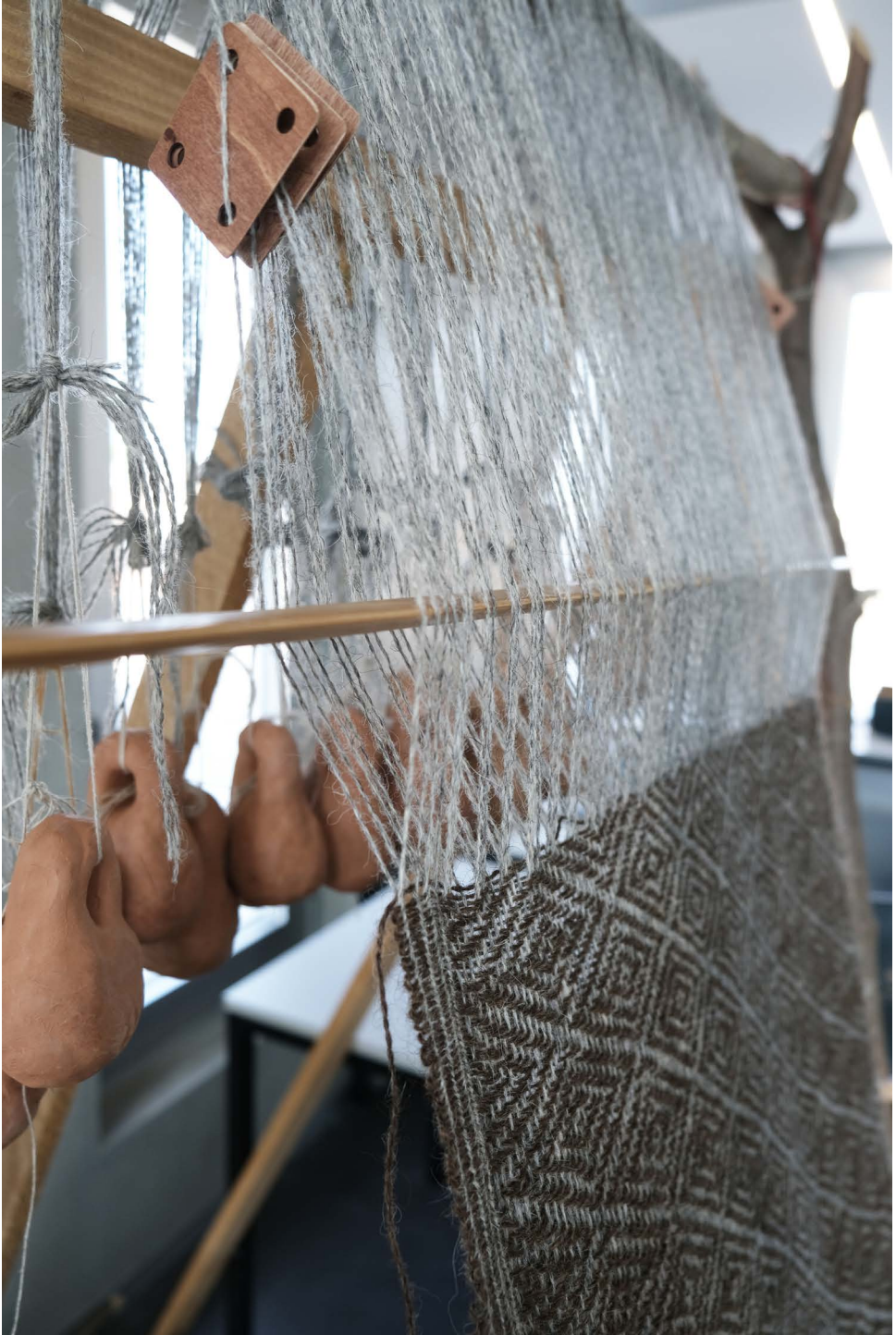
Figure 129 : La jupe en cours de tissage : rotation de la barre de saute afin d'ouvrir la foule. La lisière latérale est effectuée aux plaquettes et les pesons sont à l'arrière (Photo A. Viranyi).
