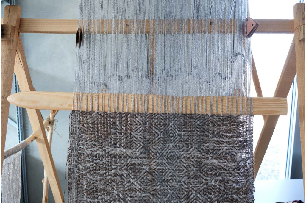
Figure 131 : La jupe en cours de tissage. La barre de saute est passée entre les fils de chaîne pour créer le motif (Photo A. Viranyi).
