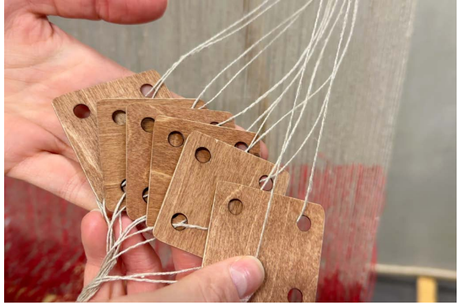
Figure 103 : Enfilage des plaquettes pour la lisière latérale de la tunique (Photo M.-I. Bensaïd).
